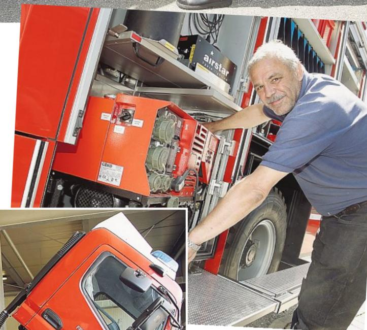
▲ Balthasar Nusser führt vor: Ohne Kraftaufwand wird das schwere Aggregat aus dem Wagen geschwenkt.
